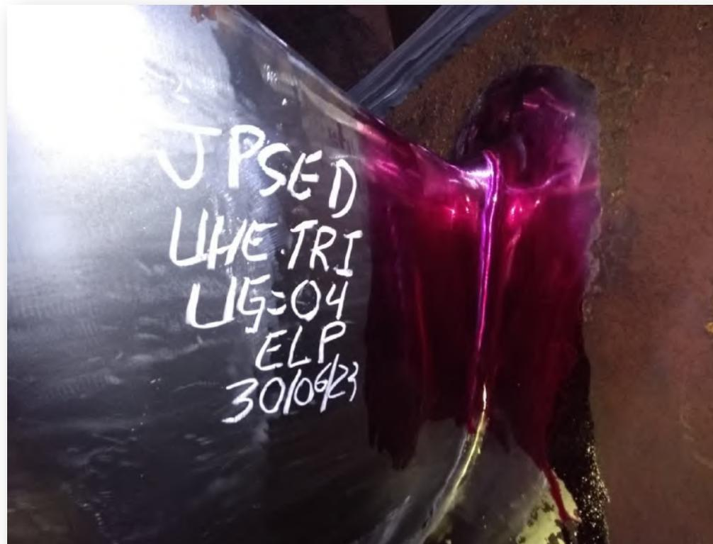
*Inspeção na solda na pá do rotor da turbina UG-04*
